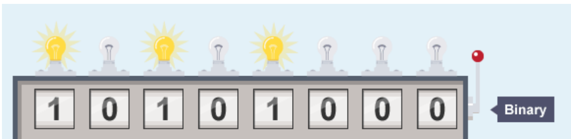
රූපය 1.2. 1 ද්විමය 10101000 යන සංඛ්‍යාව 1 හා 0 යන ඉලෙක්ට්‍රොනික් (විචාන හෝ සංචාන) අනුක්‍රමයක් ලෙස නිරූපණය කර ඇත.
