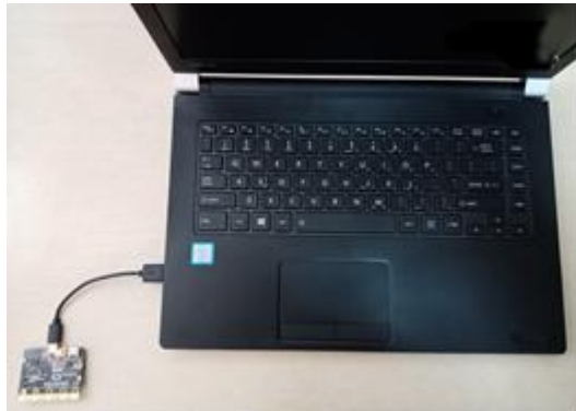
රූපය 5.1. 12 Micro Bit පරිපථය USB රැහැන් හරහා පරිගණකයට සම්බන්ධ කළ විට
